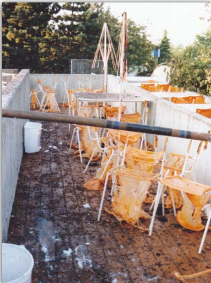
Die Bestuhlung der Cafeteria im Außenbereich ist durch die enorme Hitzestrahlung geschmolzen.
